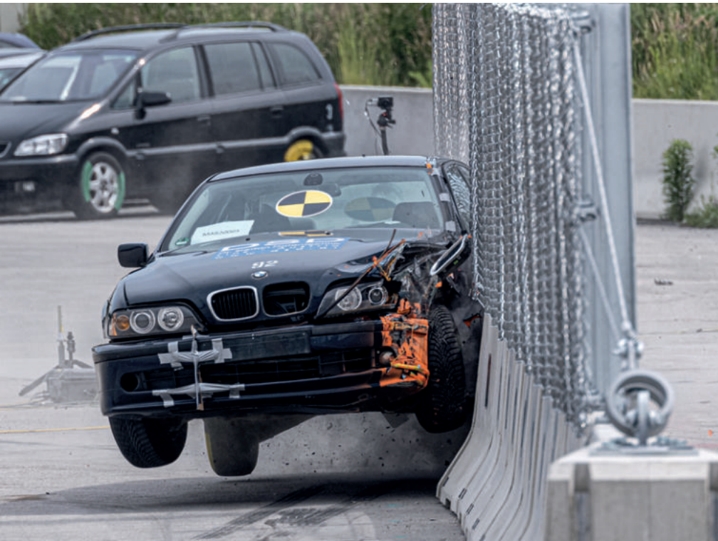
Obr. 4: Nárazová skúška TB32
